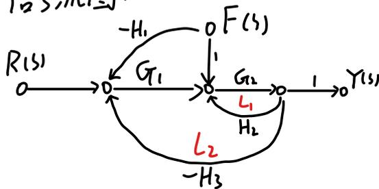
回路  $L_1 = G_2 H_2$ ,  $L_2 = -G_1 G_2 H_3$
