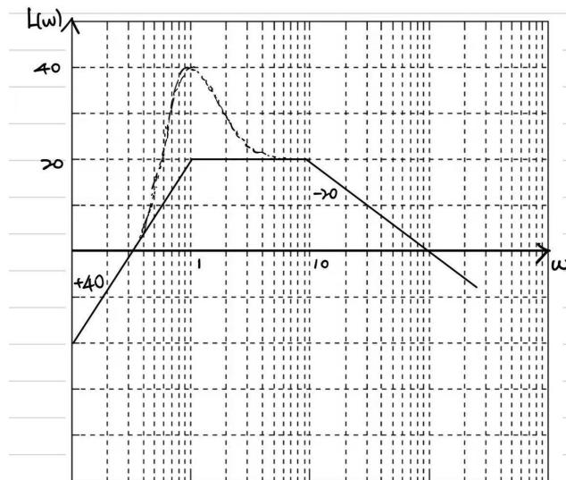
由图，积分环节，二阶振荡，和惯性环节
