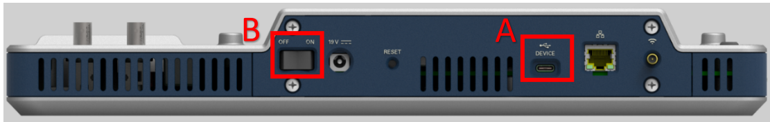
图 3-20 ELVIS III 平台开关及 USB 接口示意图
