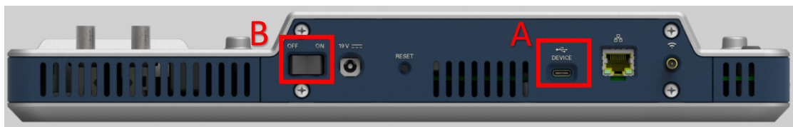
图 3-8 ELVIS III 平台开关及 USB 接口示意图
