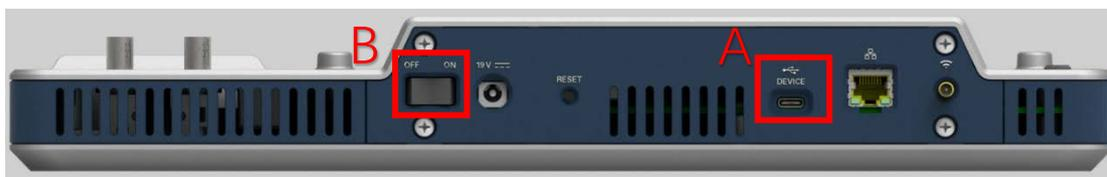
图 3-3 ELVIS III 平台开关及 USB 接口示意图
