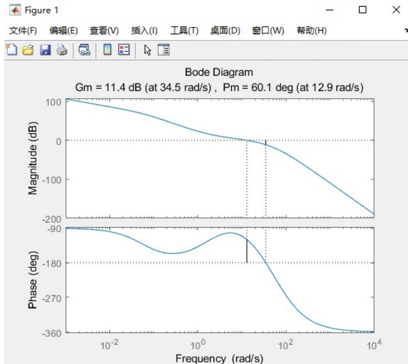
由图得, 此时系统剪切频率为  $12.9 \text{ rad} \cdot \text{s}^{-1}$ , 相角裕度为  $60.1$  度.
