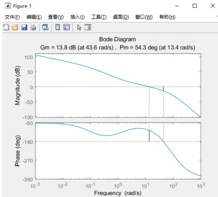
由图得, 剪切频率  $13.4 \text{ rad}\cdot\text{s}^{-1}$ , 相位裕度  $54.3 \text{ deg}$ .
