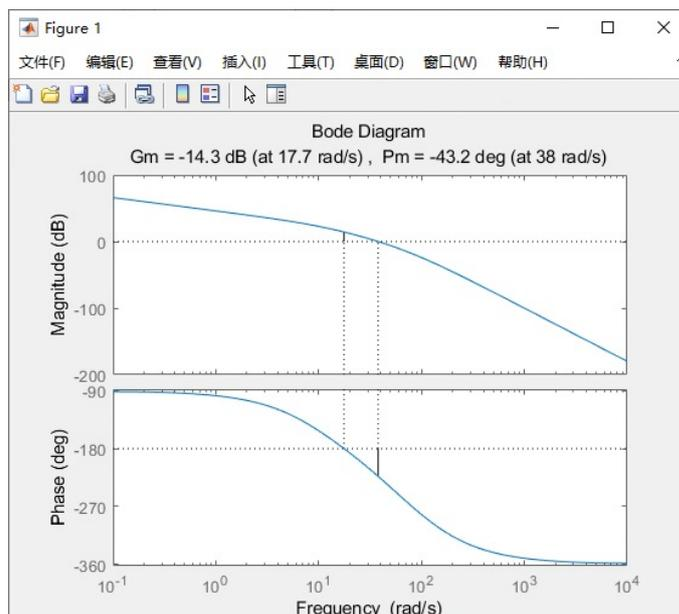
由图得, 此时剪切频率为  $38 \text{ rad}\cdot\text{s}^{-1}$ , 相角裕度为  $-43.2$  度.
