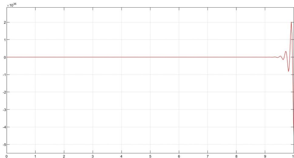
由图得系统发散, 无法计算超调和调节时间.
