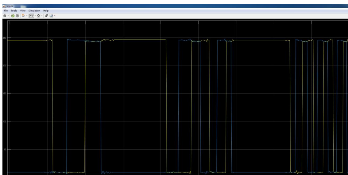
图 3-2-9 A、B 两相脉冲波形显示（相对图 3-2-8 负向）
