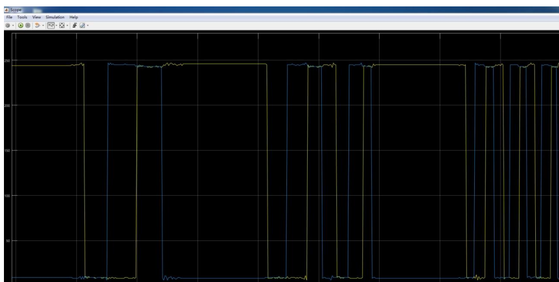
图 3-2-9 A、B 两相脉冲波形显示 (相对图 3-2-8 负向)
