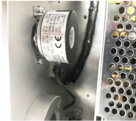
图 1-7 增量式编码器示意图
