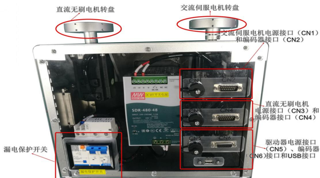
图 1-1 电机调试平台内部结构示意图
