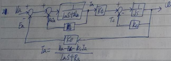
20. 直流电动机系统中滞阻系数为  $K_r$ , 电流反馈系数为  $K_i$ ,  $R I_a(s) = \frac{[U_a(s) - E_a(s) - K_i I_a(s)]}{(Ls + R_a)}$
