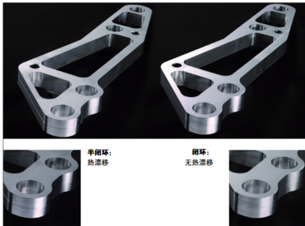
图6: 连杆, 一个毛坯加工两次
