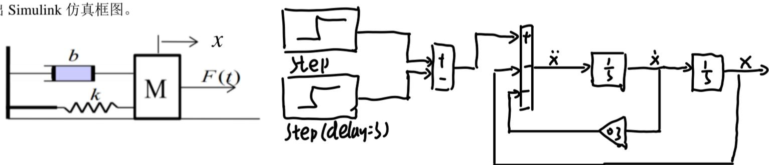
解：由  $F(t) - kx - b\dot{x} = M\ddot{x}$ ，代入数据，有  $\ddot{x} = -0.3\dot{x} - x + F$
