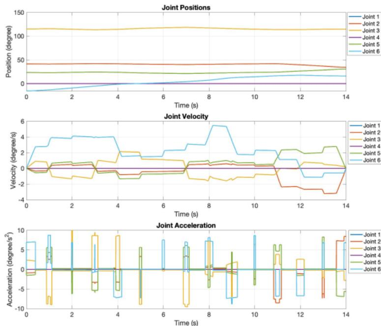
LFPB规划得出的关节位移、速度和加速度
