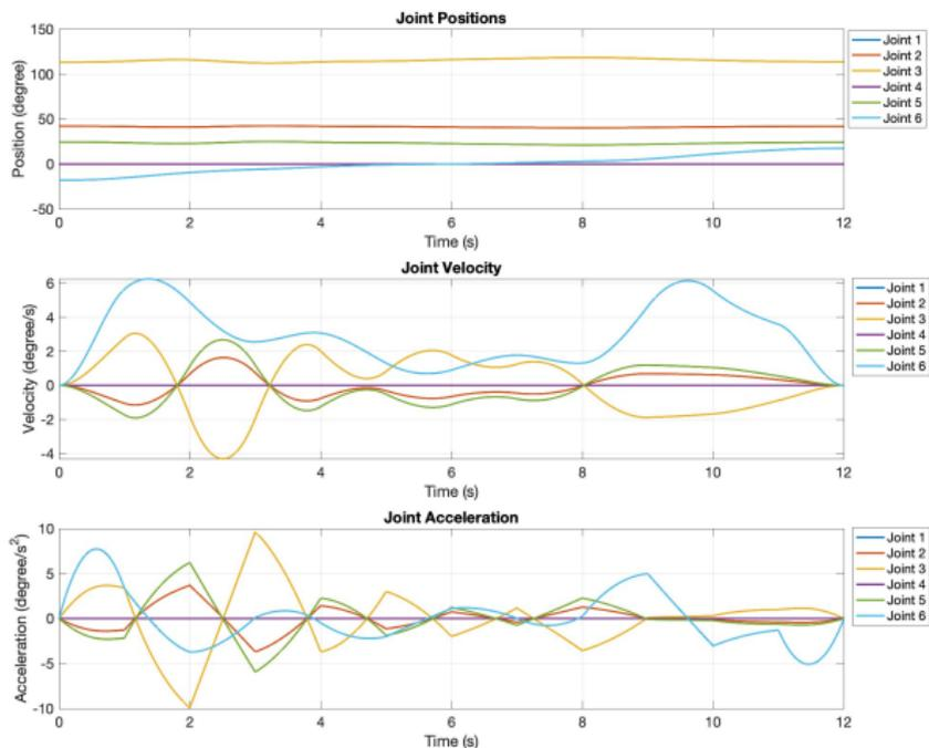
B-样条曲线规划得出的关节位移、速度和加速度
