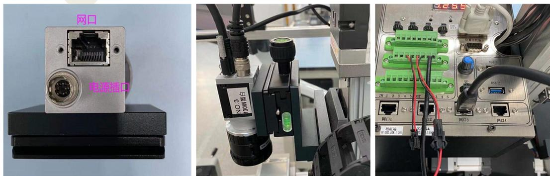
图 1-8 连接相机示意图
