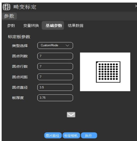
图 1-18 畸变标定工具参数设置界面
