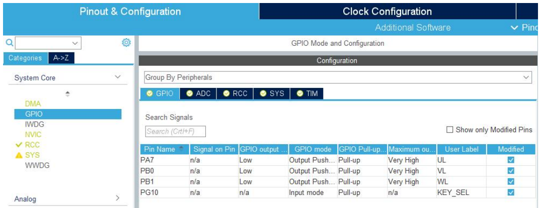
图 1-21 GPIO 引脚配置
