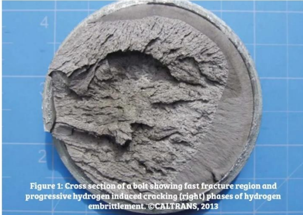
发生氢脆的保险螺栓横断面
