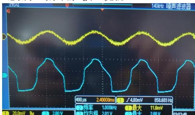
输入信号或内部非线性元件可能产生不同频率分量，且功放电路对不同频率增益不同，导致波形出现频率失真。
