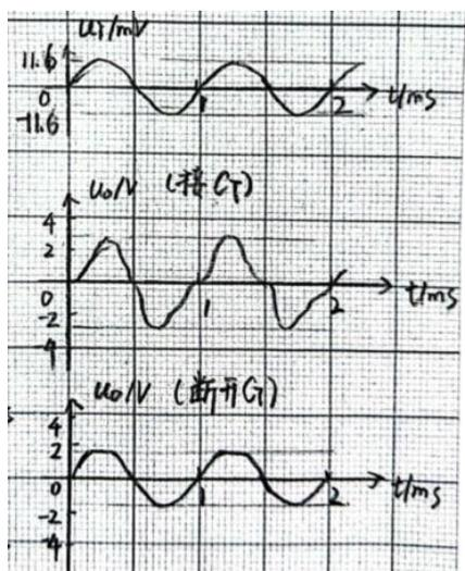
当接上  $C_7$ ，调节输入使电压最大且不出现底部失真后，若断开  $C_7$ ，此时产生顶部失真。
