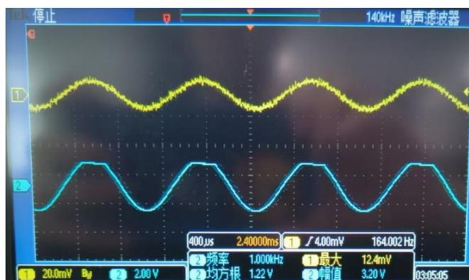
断开  $C_7$  后，输出电压出现顶部失真。
