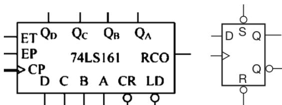
(3) D 触发器芯片若干，图形如上右图，S 为异步置位端，R 为异步复位端，三角为时钟输入端，上升沿触发。
