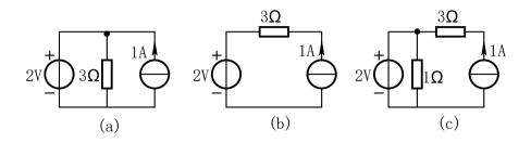
例 2 (习题 1.16) 求图示电路受控源和独立源各自发出的功率。
