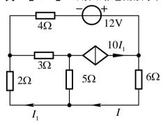
例 3 【2.21】列写节点①的节点电压方程。
