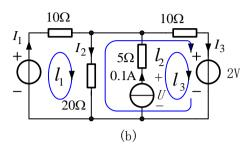
例 2【2.14】 用回路电流法求图示电路的电流 I。
