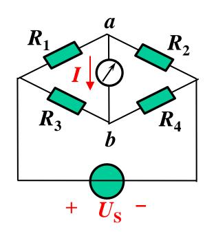
当4个电阻的关系满足  $\frac{R_1}{R_2} = \frac{R_3}{R_4}$ 时,a与b等电位,检流计中无电流,即 I=0,电桥处于平衡状态。
