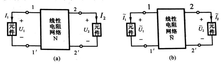
设网络内共有b条支路,各支路电压和电流均取<u>关联/非关联参考方向</u>,且两条支路对应电压电流参考方向取向相同。由特勒根定理
