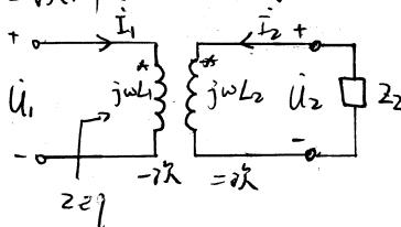
$$\begin{cases} jwL_1 i_1 + jwM i_2 = u_1 \\ jwM i_1 + jwL_2 i_2 + Z_2 i_2 = 0. \end{cases} \rightarrow \text{为何?} \quad \text{列写相量形式的} \quad \text{电路方程.}$$
