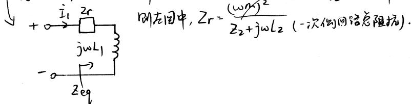
$$\text{即左图中, } Z_r = \frac{(wM)^2}{Z_2 + jwL_2} \quad (\text{一次侧回路总阻抗}).$$
