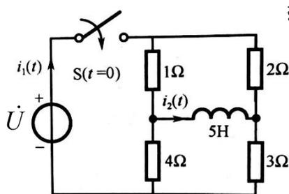
求5H电感看进去的戴维南等效电路。(将电路化为RL串联电路)
