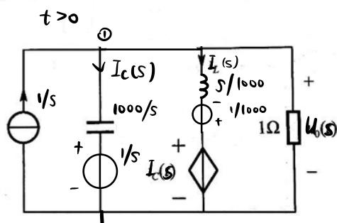
解: 开关闭合前电路处于稳态, 电容在直流状态下相当于开路,  $i_C(t)=0$ , 故复频电压源上也无电压升降, 电感相当于短路。
