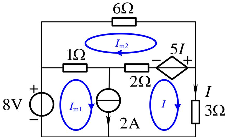
电流源有端电压存在，应列入方程
