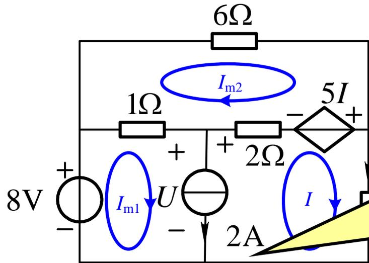
电流源端电压与源电流是关联参考方向，直接相乘，所求功率是吸收功率，故前面填加负号，表明最后结果是发出功率
