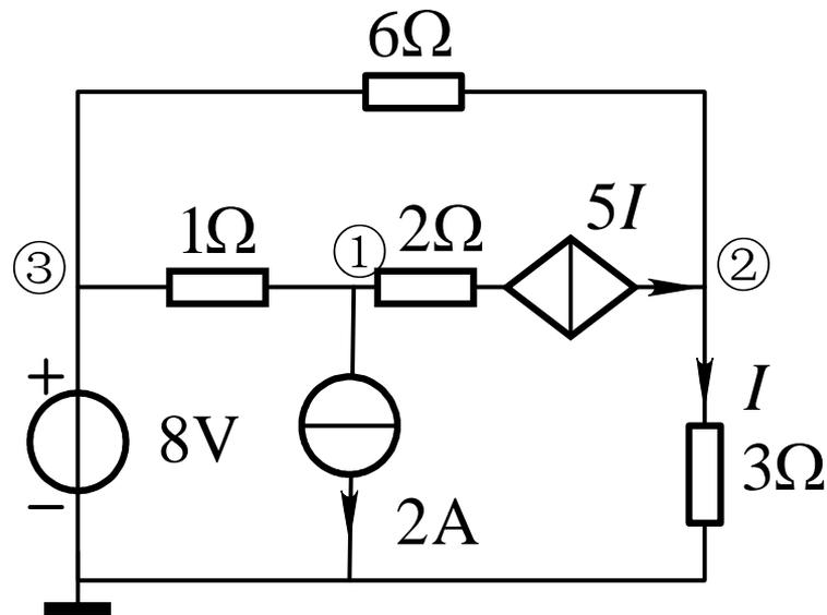
在节点电压方程中，与电流源串联的电阻不计入自导和互导中
