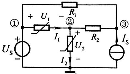
12.7 图示电路中两个非线性电阻的伏安特性为  $I_1 = U_1^3$ (单位:A,V),  $U_2 = I_2^3$ (单位:V,A)。试列出求解  $U_1$  及  $I_2$  的二元方程组。
