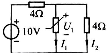
12.2 图题 12.2 所示电路，已知非线性电阻的特性方程为  $U = 2I^2 + 1$  (单位: V, A), 求电压  $U_1$ 。
