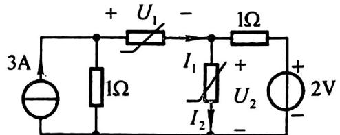
12.10 如图题 12.10(a)中非线性电阻的电压、电流关系如图题 12.10(b)所示, 求电压  $U$ 。
