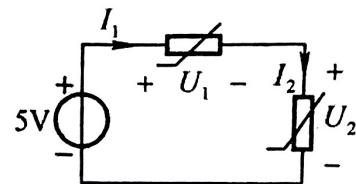
12.4 设图示电路中非线性电阻均为压控的， $I_1=f_1(U_1)$ ,  $I_2=f_2(U_2)$ 。列出节点电压方程。
