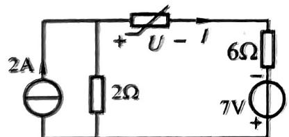
12.3 图示电路，已知  $I_1 = 0.1\sqrt{U_1}$  (单位: A,V) ( $U_1 \geq 0$ )， $I_2 = 0.05\sqrt{U_2}$  (单位: A,V) ( $U_2 \geq 0$ )。求  $I_1$  和  $U_1$ 。
