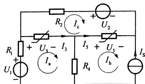
12.6 图示电路中非线性电阻的特性为  $U_1=f_1(I_1)$ (流控的),  $I_2=f_2(U_2)$ (压控的)。试列出改进节点电压方程。
