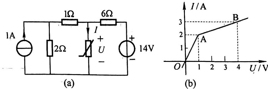
12.13 非线性电阻电路如图所示, 已知  $i_s = [2 + 6 \times 10^{-3} \cos(\omega t)]A$ , 非线性电阻为电压控制型, 其伏安特性曲线为  $i = 2u^2 + 1$  ( $u \geq 0$ , 单位: A, V), 用小信号分析法求电压  $u$  和电流  $i$ 。
