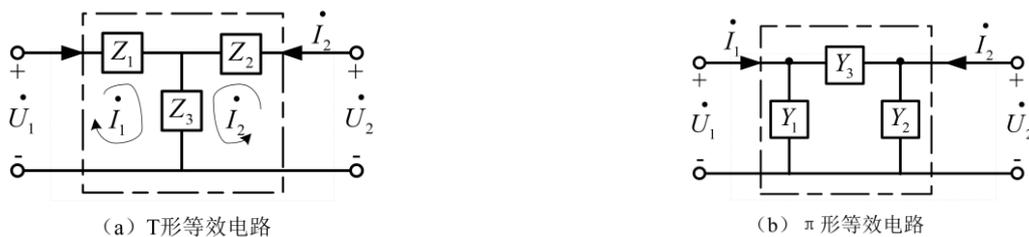
图 3-7 互易二端口网络的 T 形和  $\pi$  形等效电路
