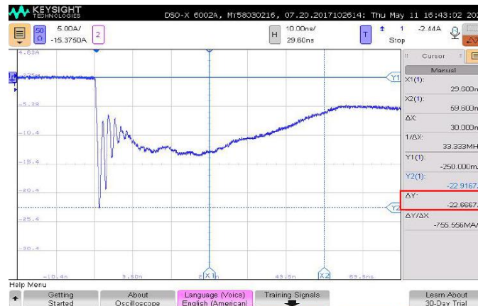
图 12 -6kV 电流波形第一峰值的电流波形图
