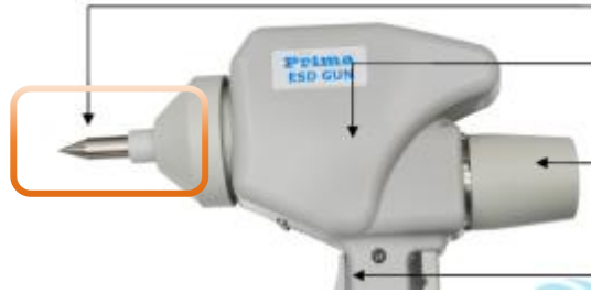
图 33 静电枪圆锥形的放电电极
