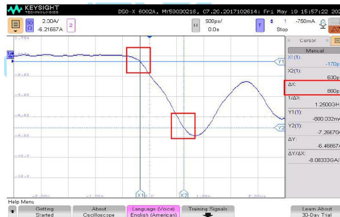
图 13 -6kV 电流波形的上升时间波形
