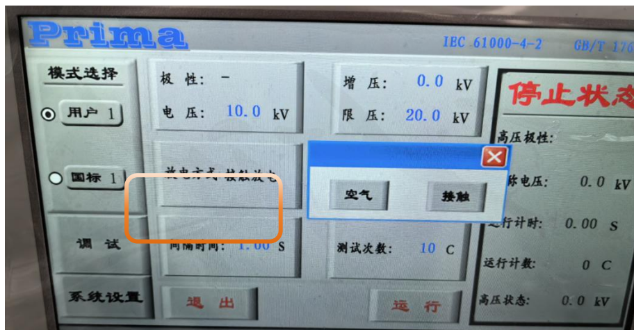
图 32 放电方式选择接触放电
