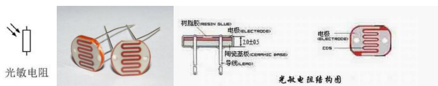
图 6-1 电阻符号、外形及结构
