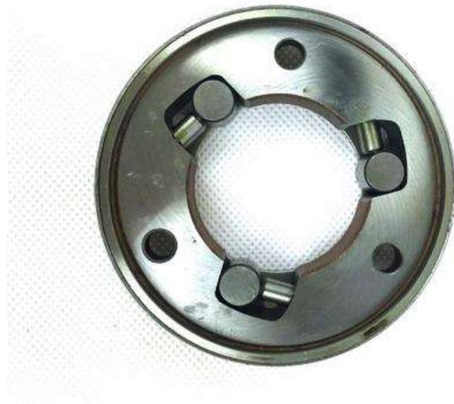
摩托车轮的超越离合器
