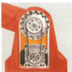
工业机器人关节(同步带)
