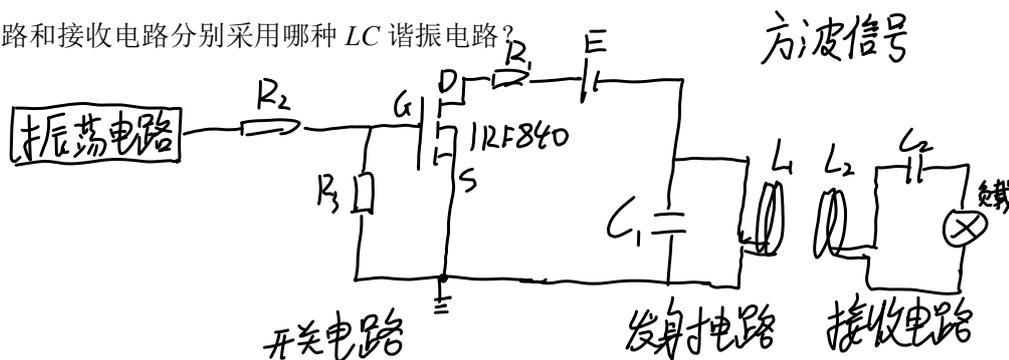
发射电路: 并联 LC 谐振
