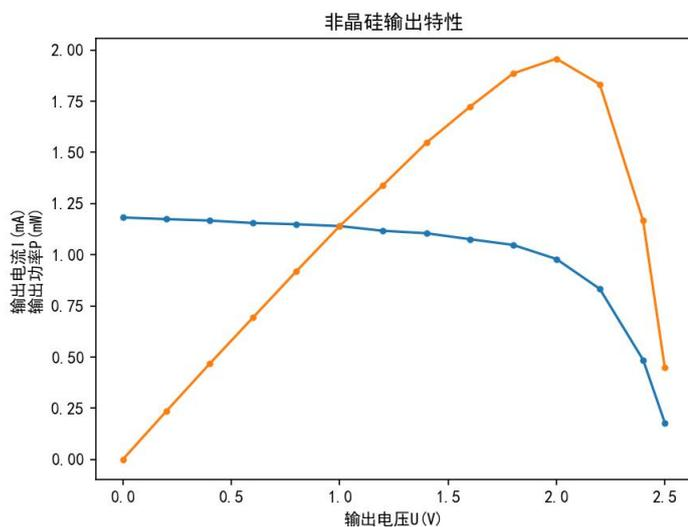
其中蓝线为输出电流，橙线为输出功率， $P_{max}=1.958mW$ ,  $R=2042.9\Omega$
