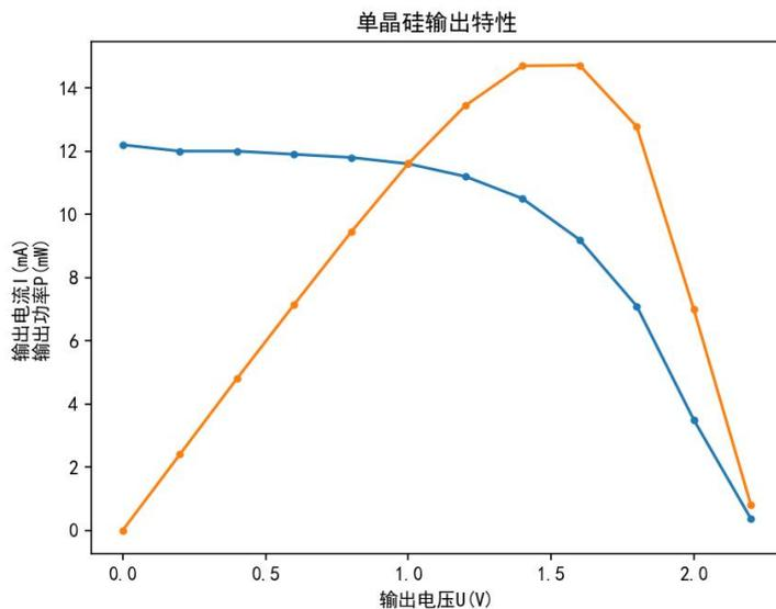
其中蓝线为输出电流，橙线为输出功率， $P_{max}=14.72mW$ ,  $R=173.9\Omega$
